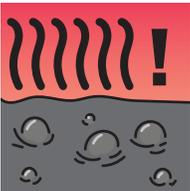
No permita que el material hierva debido a un calentamiento agresivo. El congelamiento o hervor del CleanTac ocasionará la rotura de la emulsión.
